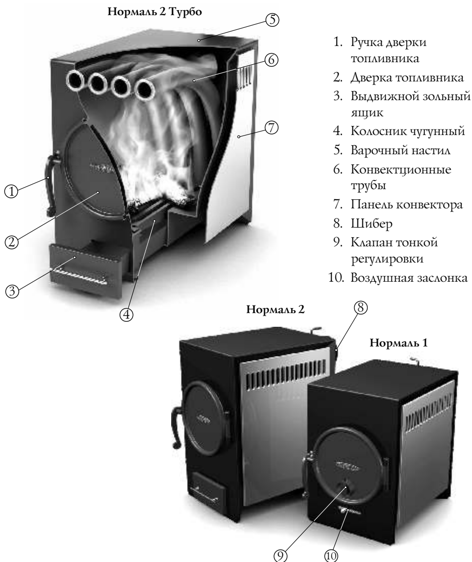
Рисунок 2. Расположение основных элементов печи «Нормаль».
