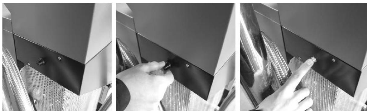
Рис. 17: Включение термического предохранителя
