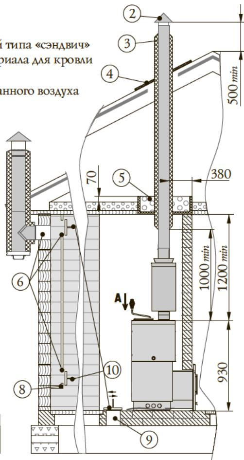
Рисунок 6. Монтаж печи в помещении из горючего материала.
