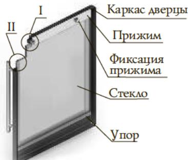
Рисунок 9. Ремонт светопрозрачного экрана дверцы модели «Люмина»
