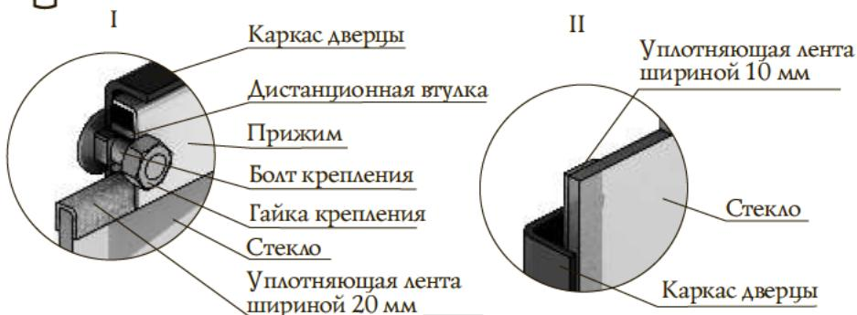
Рисунок 10. Крепление светорозрачного экрана дверцы модели «Люмина»
